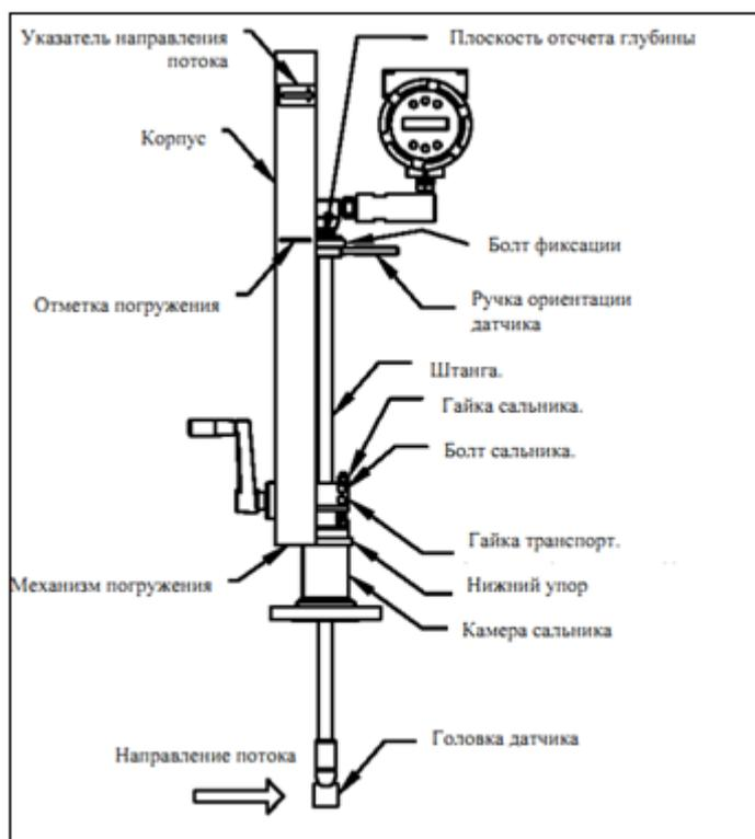
Рисунок 2-10. Расходомер с монтируемым механизмом погружения
